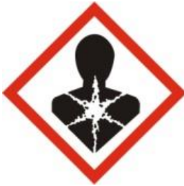
Schadelijk op termijn
