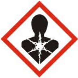
Schadelijk op termijn
